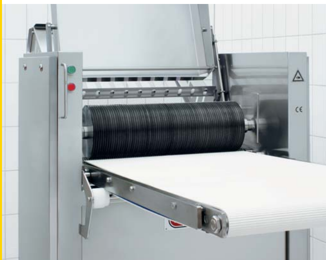
La cortadora Cortex CB 495/7K SLICER 200 con cuchillas diámetro 200 mm y distancia 8 mm; cubierta de seguridad abierta
